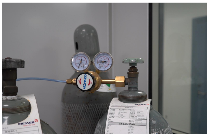
YQJ-6 钢瓶气体减压阀&氩气&入口G5/8右旋&出口 \Phi 6 卡套接头&额定流量0.6M 3 /h
