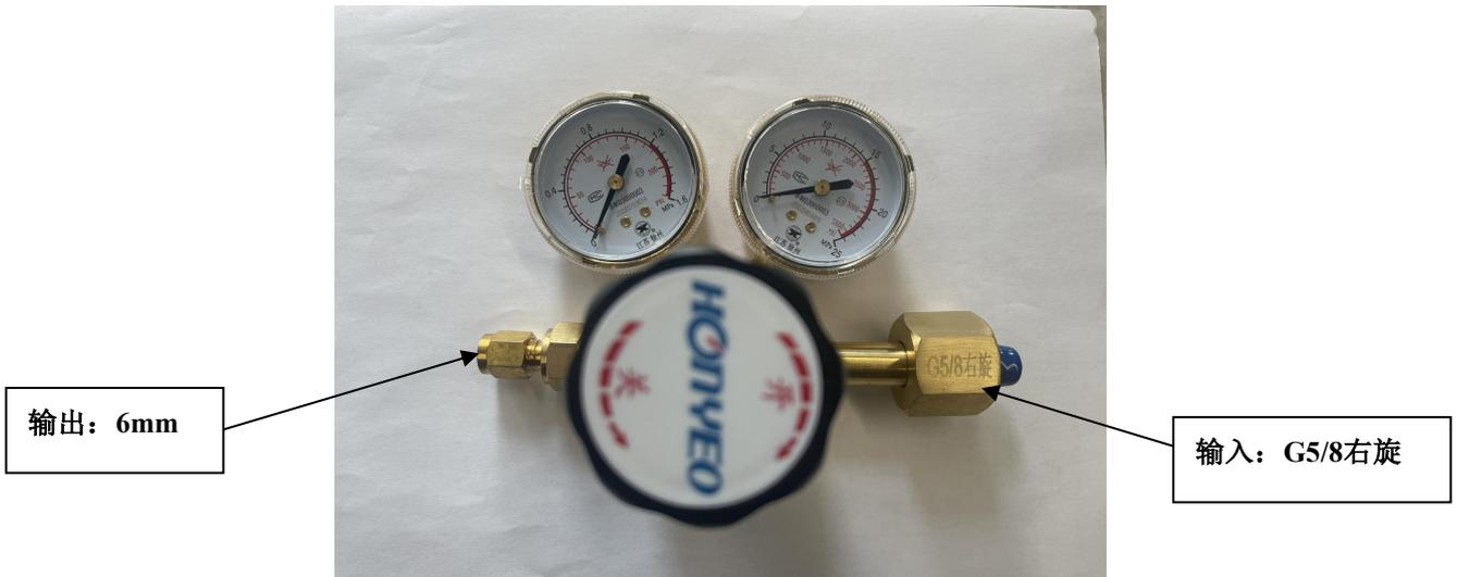
2.4.3、集中供气：实验室端减压阀规格如下图
